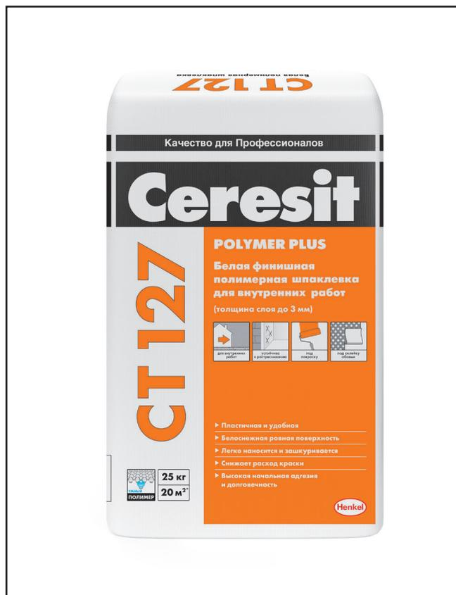
сением следующего слоя предыдущий слой после полного высыхания рекомендуется шлифовать мелкой наждачной бумагой или вольфрамовой сеткой и обработать грунтовкой СТ 17. К шлифованию, окрашиванию и оклеиванию обоями можно приступать через 24 часа после нанесения шпаклевки. Свежие остатки материала могут быть удалены водой, засохшие — только механически.
